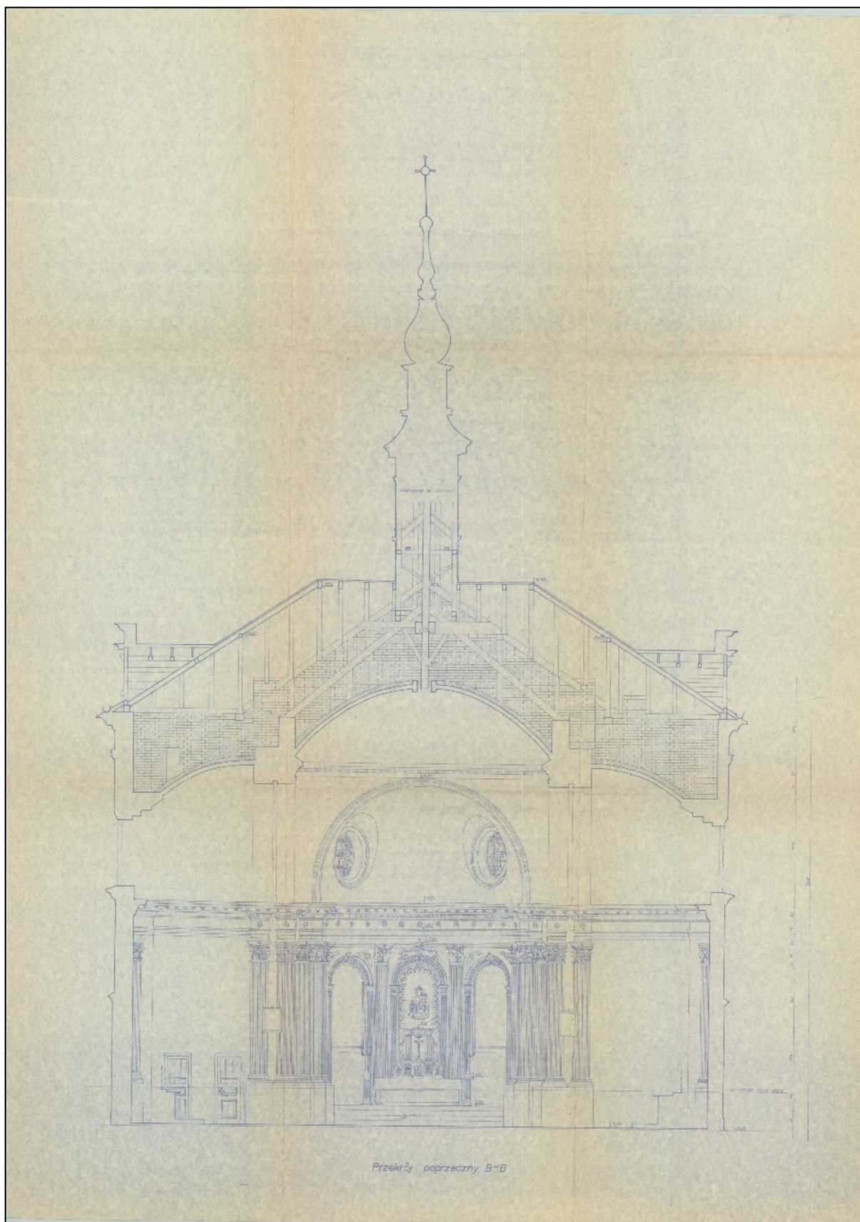
70. Przekrój pionowy kościoła w Karczewie. Inwentaryzacja J. Prokopowicza z 1982 r. Zbiory Archiwum Wojewódzkiego Urzędu Ochrony Zabytków w Warszawie.
